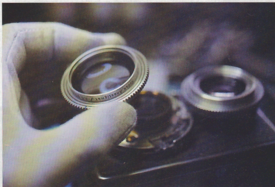
Nettoyage d'une optique sur un TLR (Twin Lens Reflex). Photo: Philippe Raybaudi
